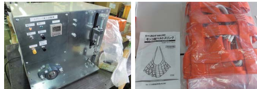
地元企業からの依頼で開発したスプリング耐久試験機 スプリングロープ縫製機で作られたベルトスプリング
