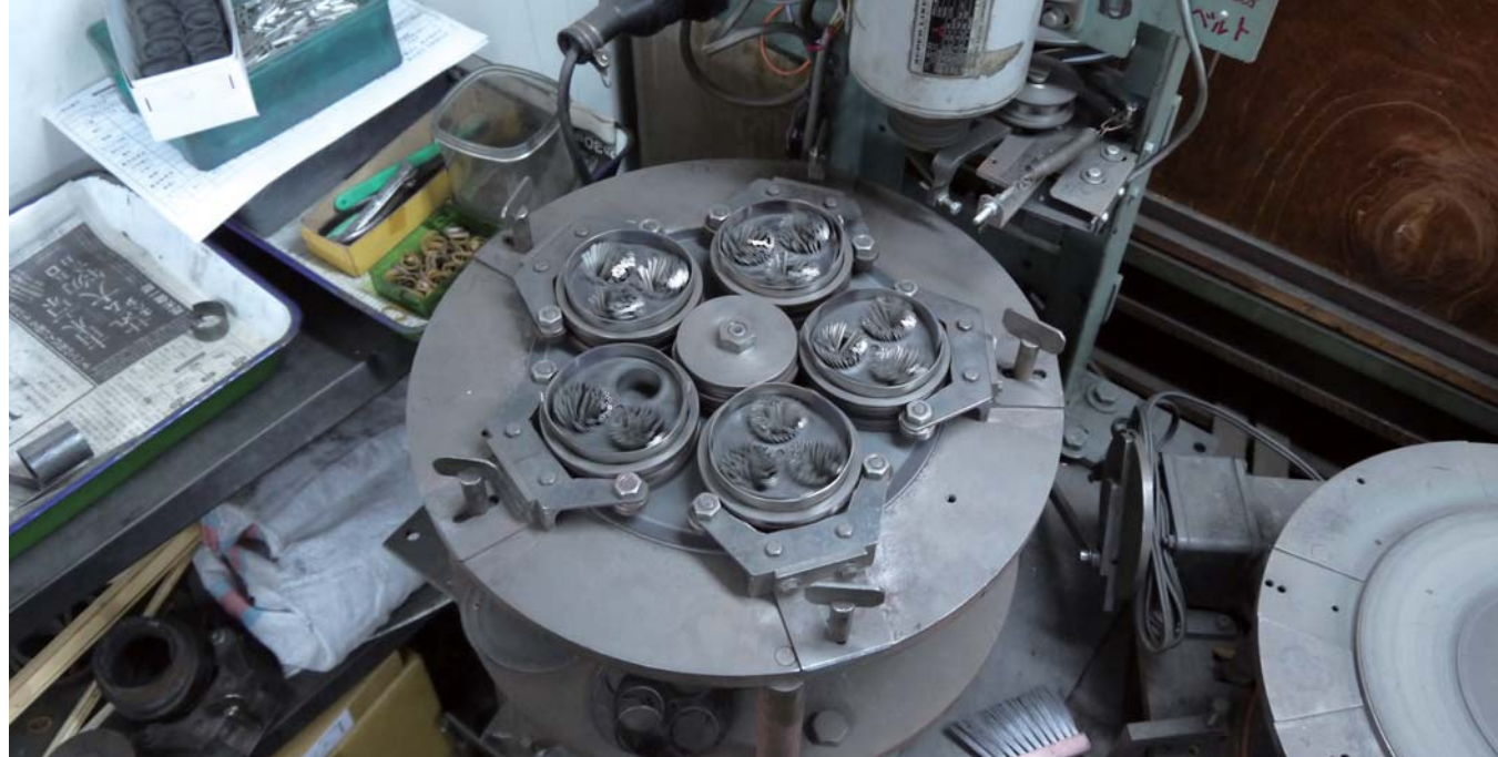
針先を球状に研磨する機械(内製)
