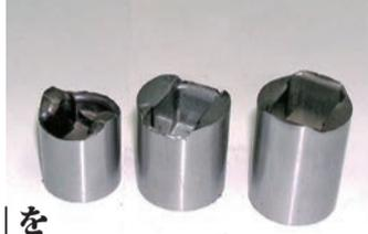
**強み** 自動車部品の「ブレーキピストン」を鋼材の切断から冷間鍛造・切削加工まで社内一貫生産
