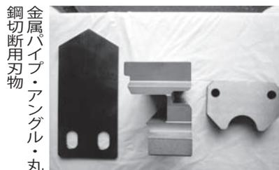
熱間鍛造用刃物 ステンレスパイプ切断刃物などを主な製品として加工しています。加工においては、すべての機械加工を一貫生産として納期・コスト、品質の改善に努めています。
