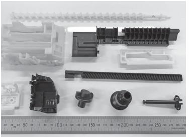
プラスチックの微細加工から大物加工まで、幅広く対応可能な設備技術を有しており、微細は直径1mmから、大物は直径400mm、長さ2mまでの加工が可能です。
