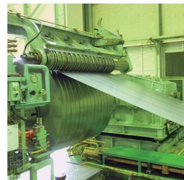
薄鋼板のコイルをレベラー、スリッター、シャーで加工し、自動車部品・事務機器・建材などさまざまな分野に提供しています。長年培ってきた技術力から生み出される加工鋼板は、平坦度や寸法、対角度の精度に優れています。
