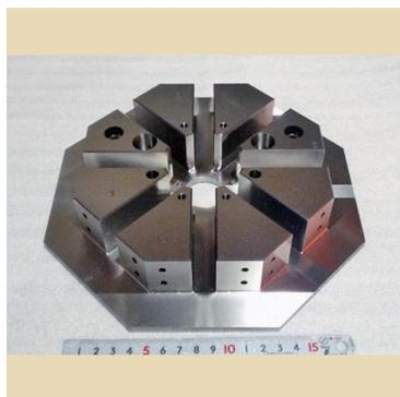
さまざまな工作機械を導入し、高精度金型部品の一貫生産体制を可能にし、取り扱う金型形状の中でも特に3次元複雑形状、焼入れ後の高硬度材の加工を得意としています。加工精度5μ以内の製品提供も可能です。
