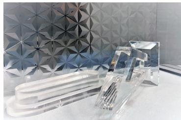
加工が可能な素材は、PMMA、PVC、PC、PP、PE、MCナイロン、POM、ABS、紙基材フェノール樹脂、布基材フェノール樹脂、PET、PEEK、ユニレート、PTFEなど。切削、接着、熱曲げ、彫刻、溶接などの手法により加工しています。
