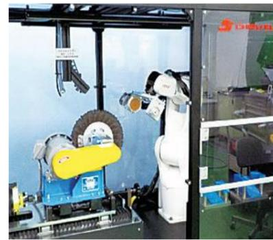
自社開発のロボット研磨システム
