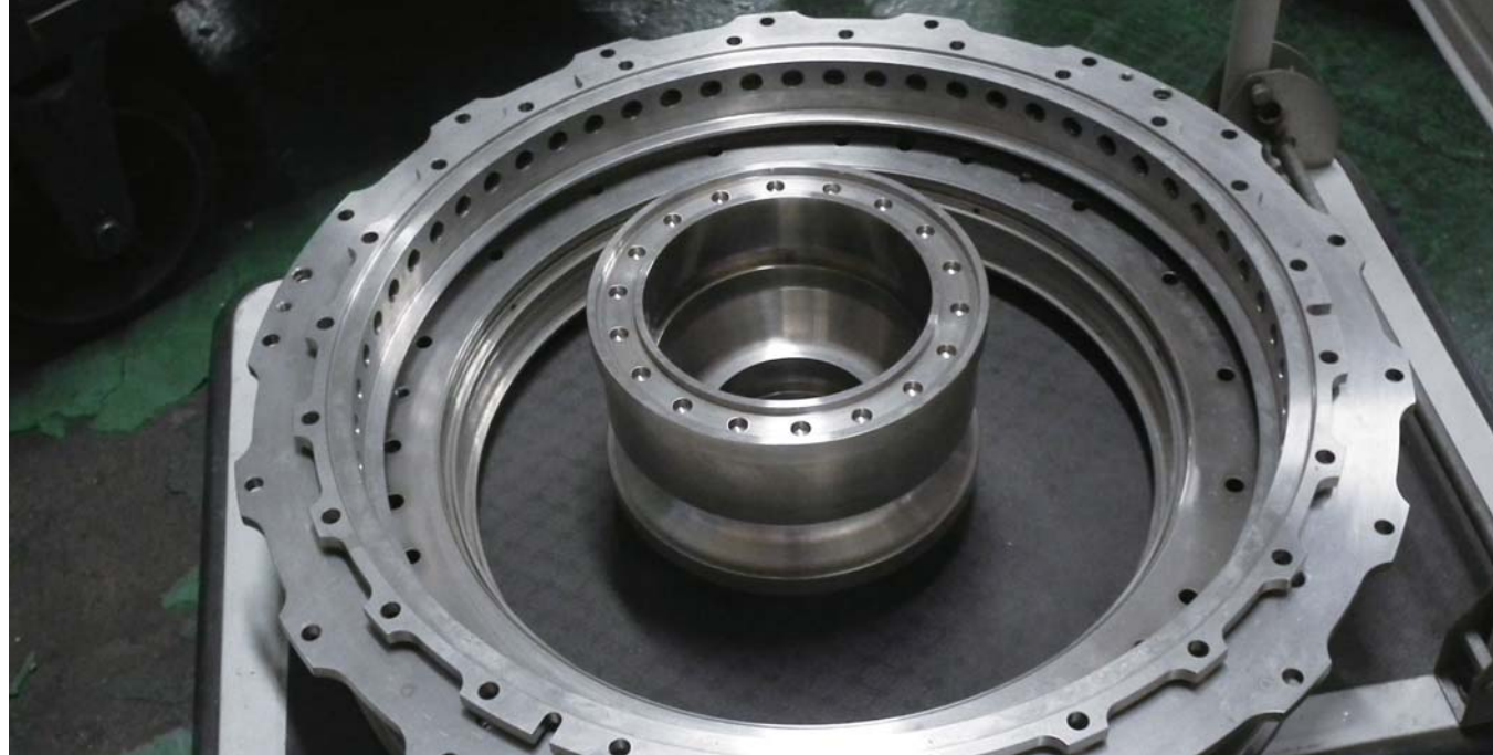
製品サンプル(インコネル製タービン部品)
