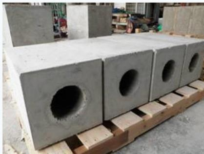
CO<sub>2</sub> 吸収型コンクリート (フェンス基礎ブロック)
