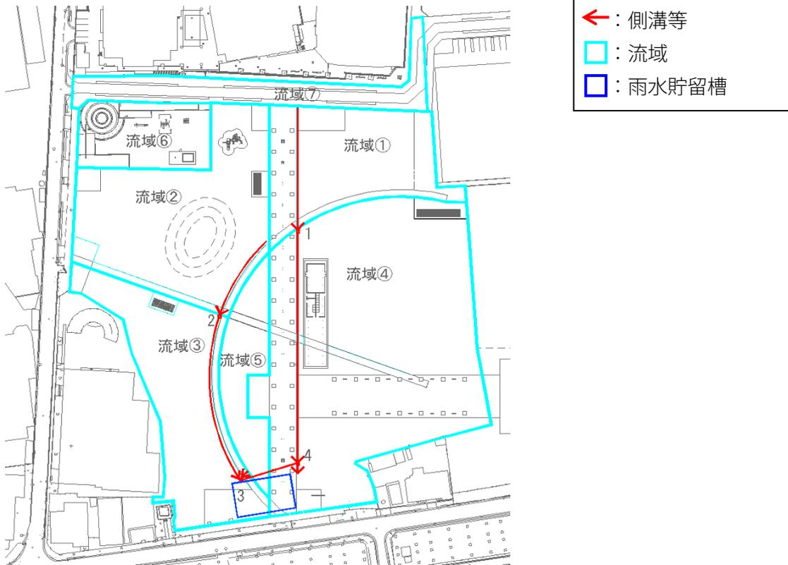
図 3.14 雨水貯留槽配置検討図
