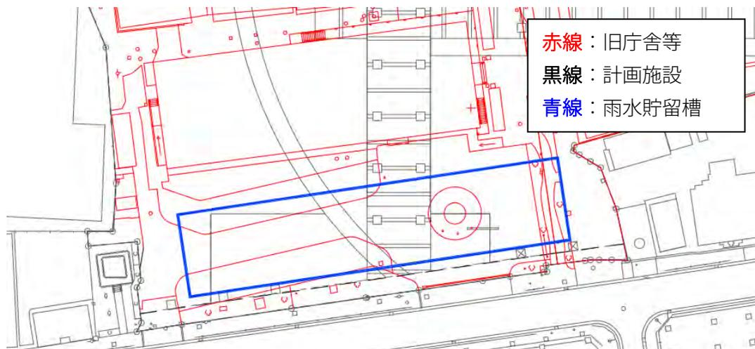
図 3.13 雨水排水概要図 (600 m<sup>3</sup>の場合)
