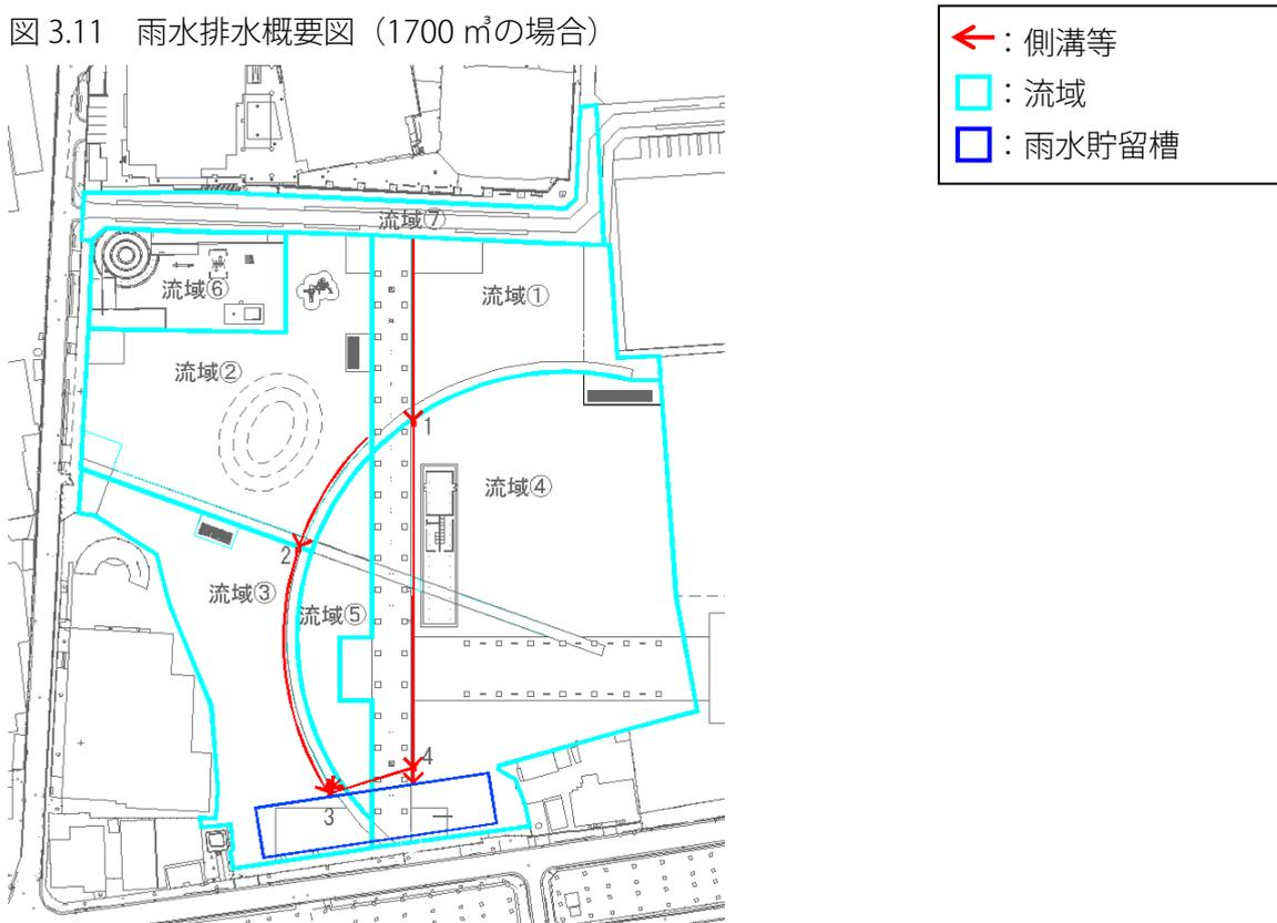
図 3.12 雨水貯留槽配置検討図
