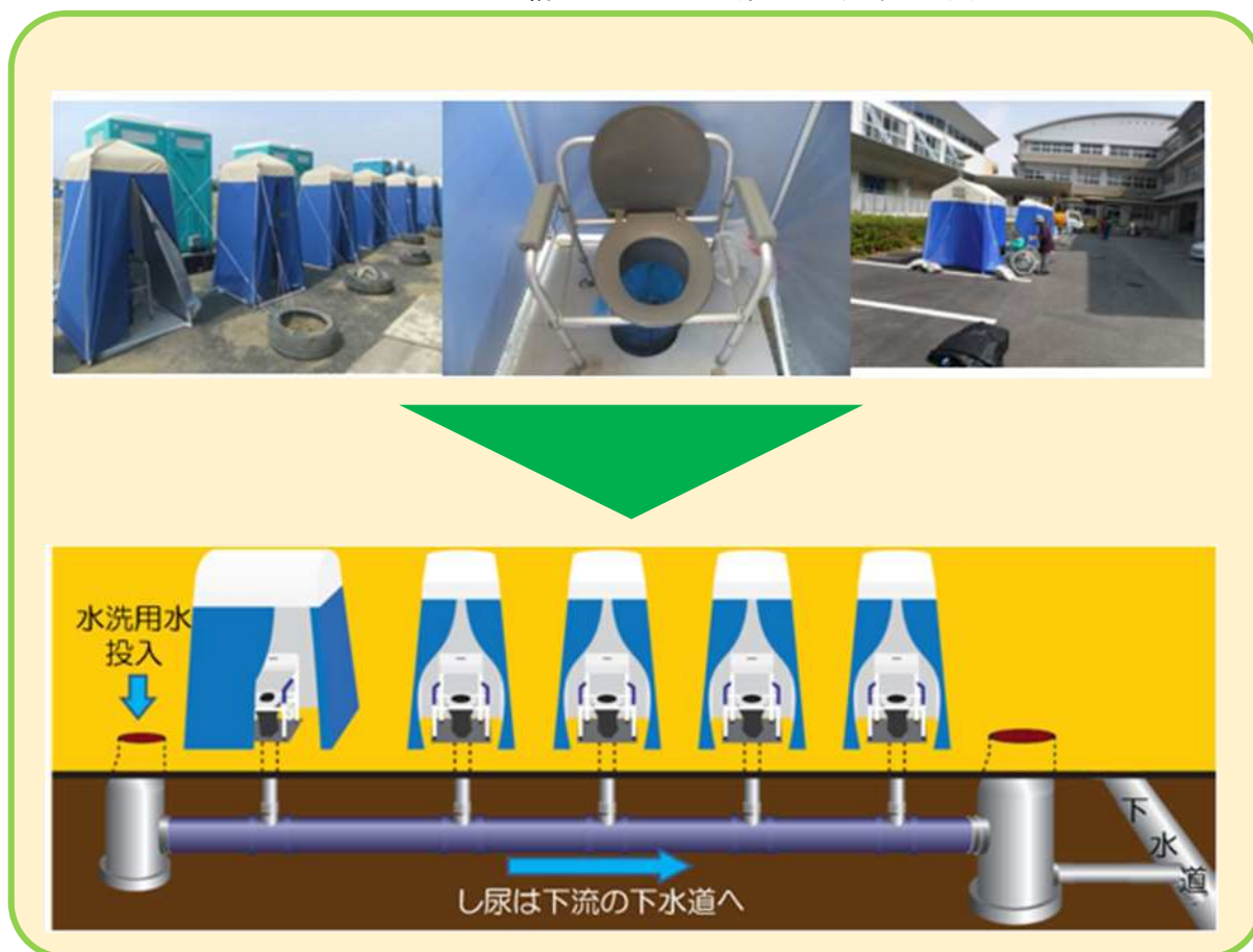
マンホールトイレの構造イメージ（国土交通省より）
