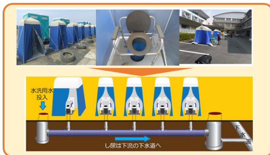
マンホールトイレの構造イメージ（国土交通省より）
