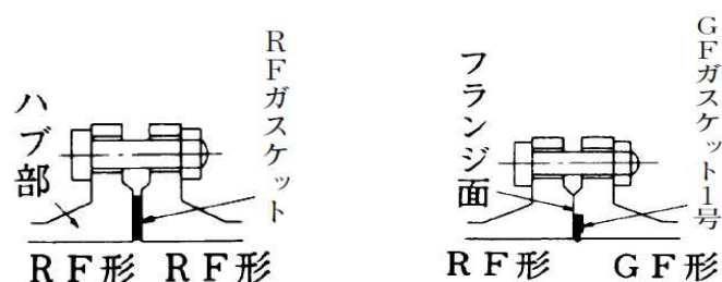
図4-17 フランジ形ダクタイル鋳鉄管の接合
