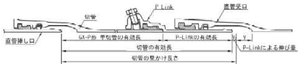
図4-16 P-Link を用いた切管有効長
