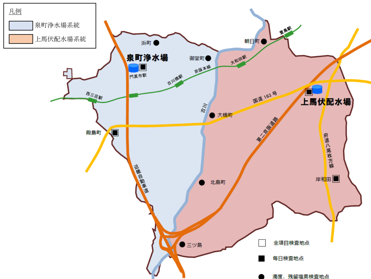
図 1 水質検査地点（配水系統図）
