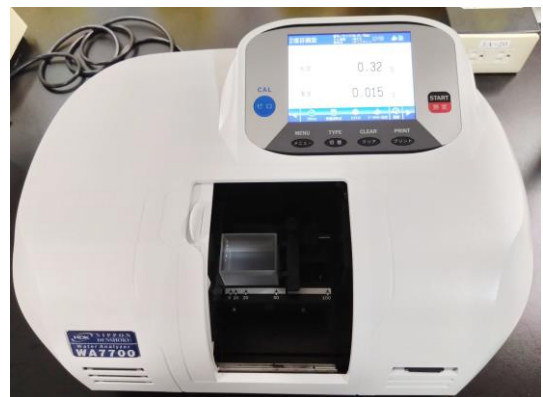
色度、濁度分析装置 (水質試験室内)
